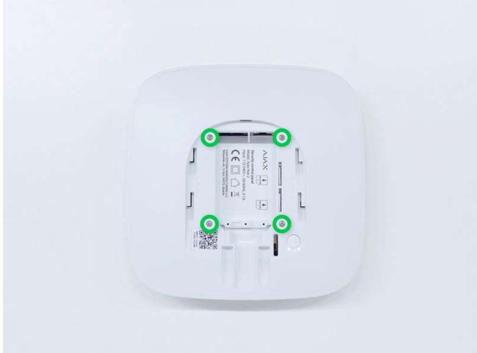
5. Entfernen Sie die Schrauben, mit denen die Platinen am Gerätegehäuse befestigt sind.
